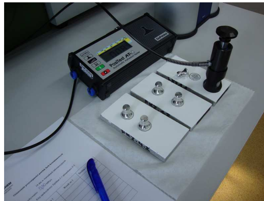
Oznaczanie przyczepności do podłoża betonowego wg ISO 4624
