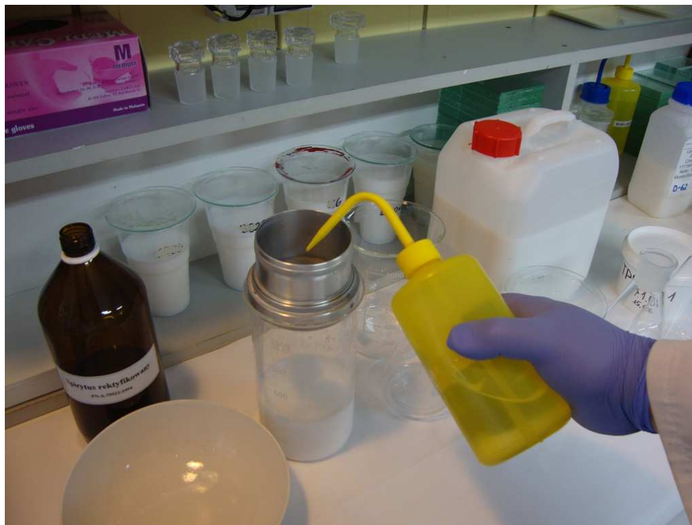
Oznaczenie zawartości koagulatu przed i po próbie stabilności
