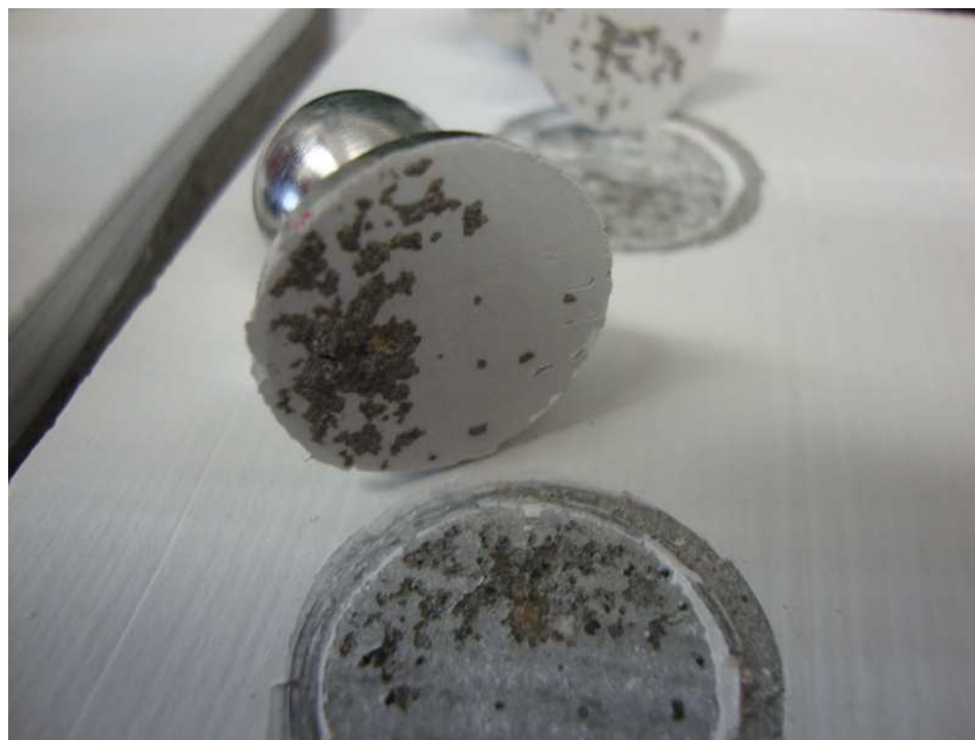
Oznaczanie przyczepności do podłoża betonowego wg ISO 4624
