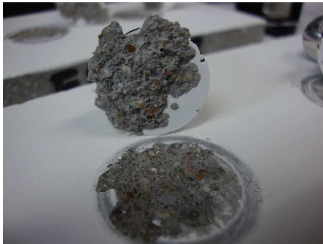
Oznaczanie przyczepności do podłoża betonowego wg ISO 4624
