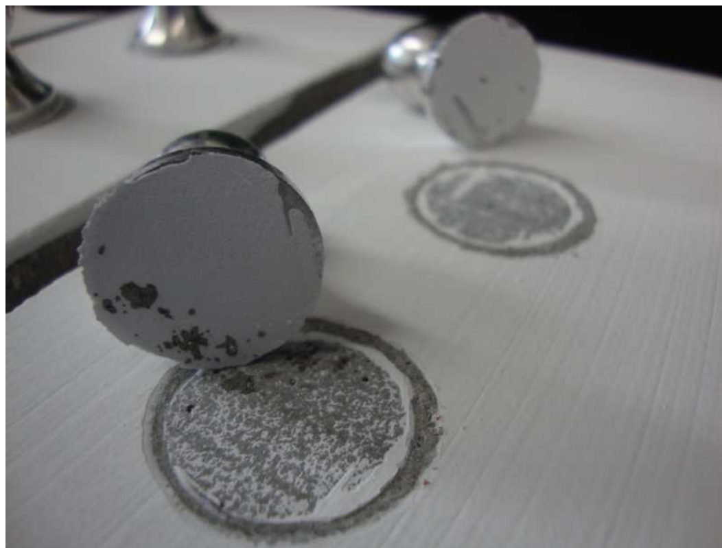
Oznaczanie przyczepności do podłoża betonowego wg ISO 4624
