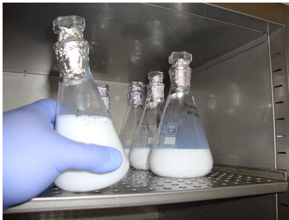
Umieszczenie kolb z mieszaninami na 48 h w 50°C
