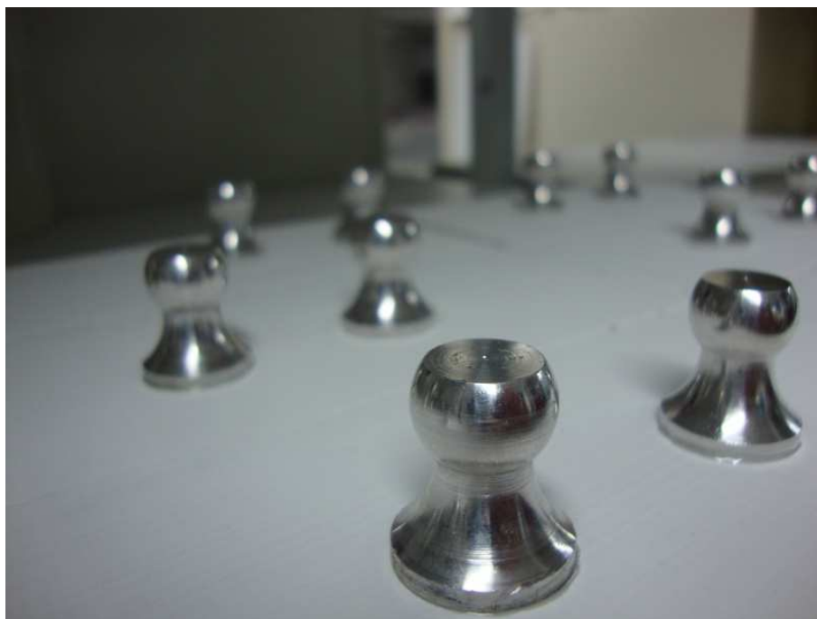
Oznaczanie przyczepności do podłoża betonowego wg ISO 4624
