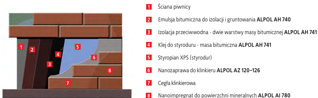
Rys. 9 Schemat NANOSYSTEMU DO KLINKIERU – wznoszenie cokołów.
