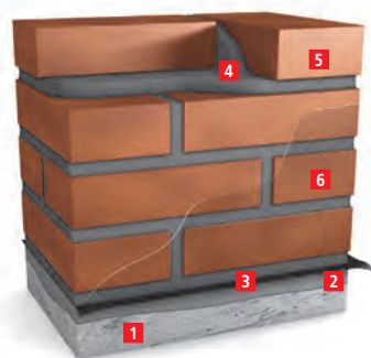
Rys. 4 Schemat NANOSYSTEMU DO KLINKIERU – murowanie ścian na pełną spoinę.
