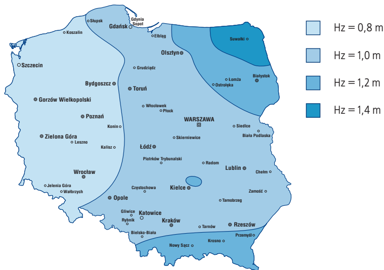
Rys. 12 Głębokość przemarzania gruntów przyjmowana dla fundamentowania.
